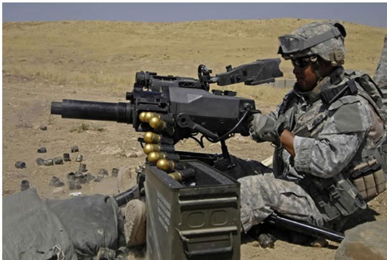
Рис. 1. Автоматический станковый гранатомет Mk47 на треноге [7]
