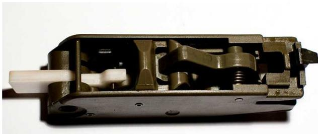
*Рис. 2.* Ударно-спусковой механизм SteyrAUG
