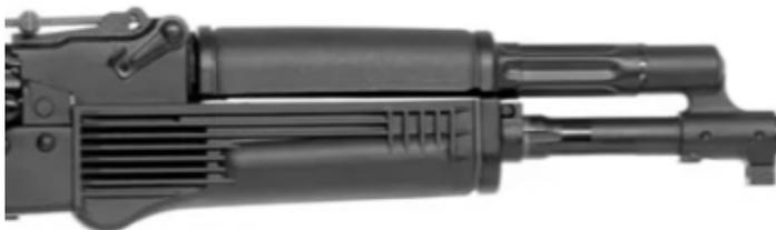
*Рис. 5. Газовый блок АК-74М*
