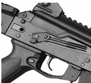
*Рис. 24.* Двусторонний предохранитель АК-12
